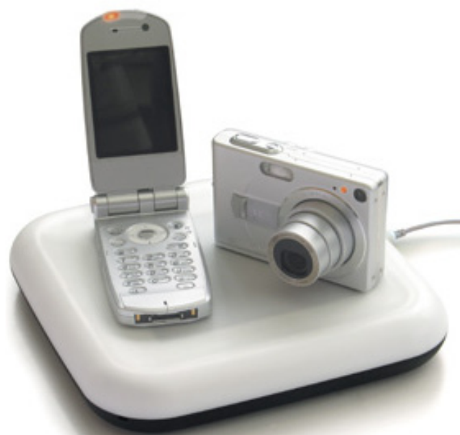
صفحه ی splashpower از القا برای شارژ مجدد همزمان چند دستگاه استفاده می کند.
